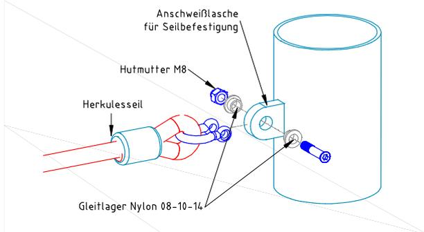
6.01. - Wackelbalken/ Handlaufstange/ Kettenabhängungen:
