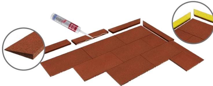
Es wird empfohlen die Rand- und Eckprofile mit dem Untergrund zu verdübeln (z.B. mittels Betonschrauben) und vollflächig zu verkleben. Die Profile werden dann mit der ersten Plattenreihe zusätzlich verklebt.
