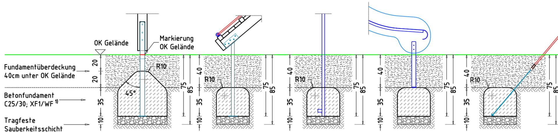
x 6 Betonfundament(e)
