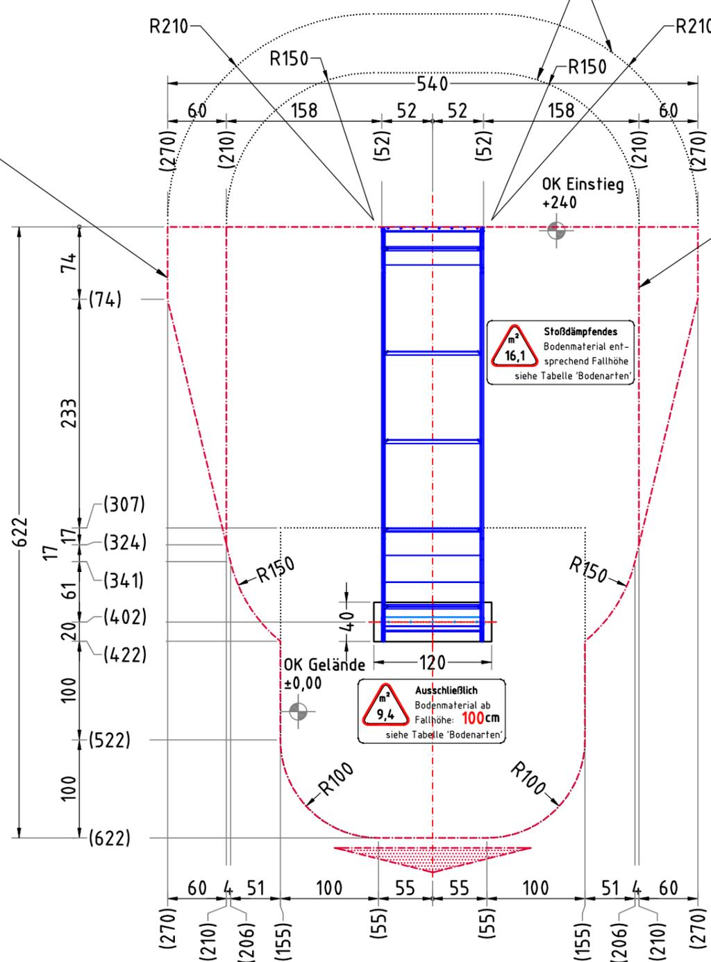
**EINBAU IM HANGVERLAUF**
