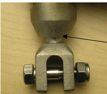
U-Bügel mit Bolzen und angeschweißter Mutter auf Verschleiß und Beschädigung prüfen
