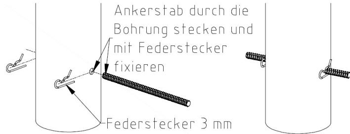
Achtung !!!!!! Die 2 Markierungsbohrungen (OK-Gelände der A-Stützen) zeigen nach innen.
