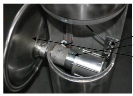
Mutter\_Sechskant M 6 entfernen Madenschraube Sechskant 4mm entfernen
