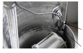
neuen Dynamo auf die Halterungsschraube schieben Handrad mit Antriebswelle in den Dynamo schieben (Dynamo nicht verkanten)
