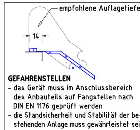
**EINBAU IM HANGVERLAUF**
